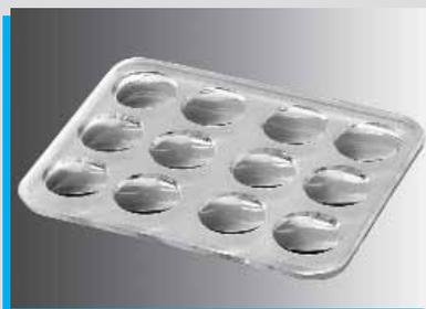
Färbepplatten mit Vertiefungen von ca. 2,3 mm Tiefe und ca. 16 mm Ø, Pressglas, Oberfläche matt, Ecken abgerundet, 10 Stück im Karton
